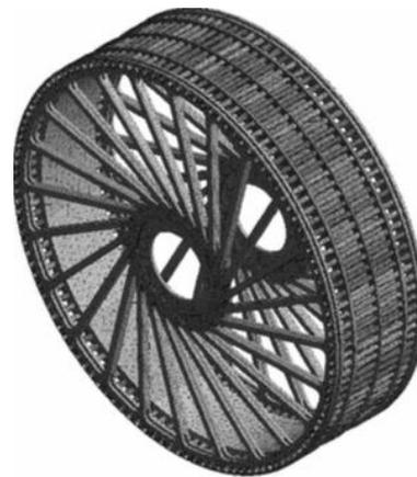
Рис. П5.31.3. Компьютерная модель ротора машины с большим диаметром.
